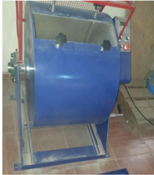
Figure 8 : Tambour de Los angeles
