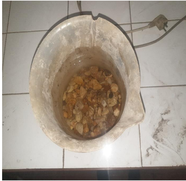
Figure 6 : Echantillon dans le récipient pour la masse volumique apparente
