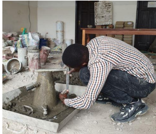
Figure 14 : Essai sur l'affaissement du béton
